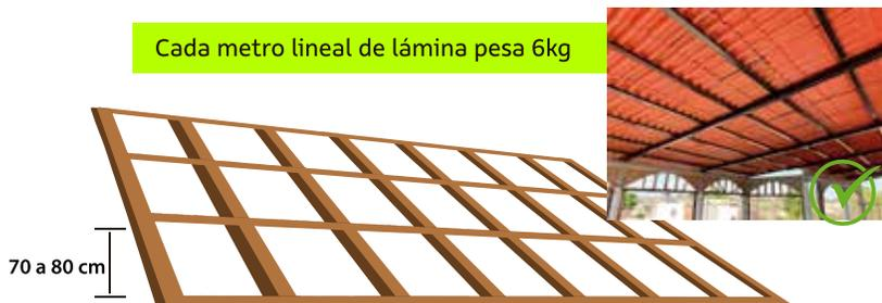
3. Montaje Traslape Longitudinal de 15 cm Transversal de 1 onda Volado máximo de 5 cm
